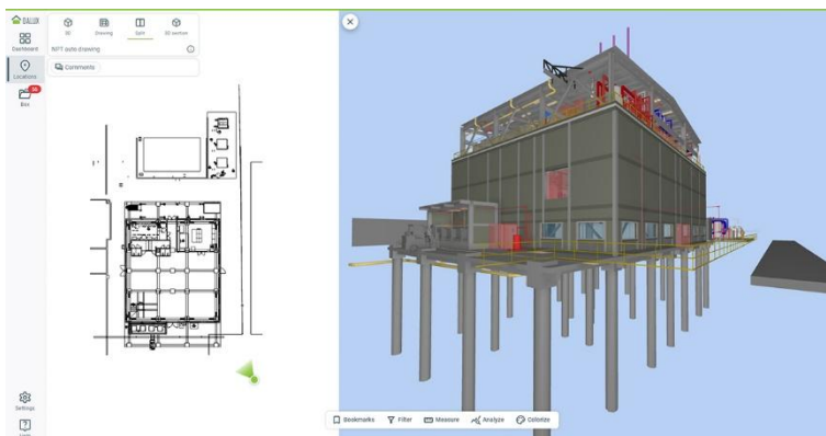
[Img 12 Ejemplo de vista. "Combinación de modelo 3D e información 2D en Dalux."]
